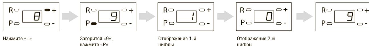
При входе в 9-й пункт меню, последовательно отображаются две цифры. После отображения цифр программа возвращается в основное меню.
