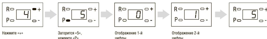
При входе в 5-й пункт меню, последовательно отображаются две цифры. После отображения цифр программа возвращается в основное меню. Первая цифра — десятки. Вторая — единицы. Полученное значение умножается на 1 000 для получения информации о количестве циклов пройденных приводом.
