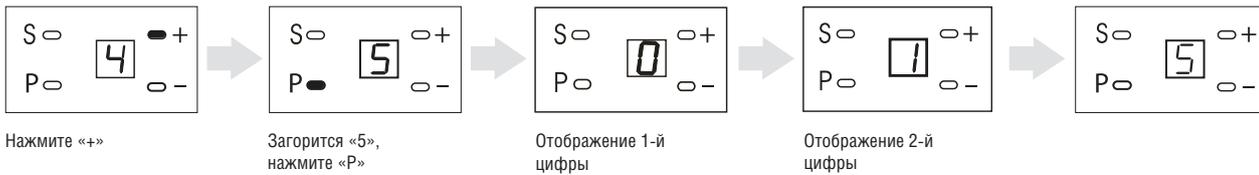
При входе в 5-й пункт меню, последовательно отображаются две цифры. После отображения цифр программа возвращается в основное меню.
