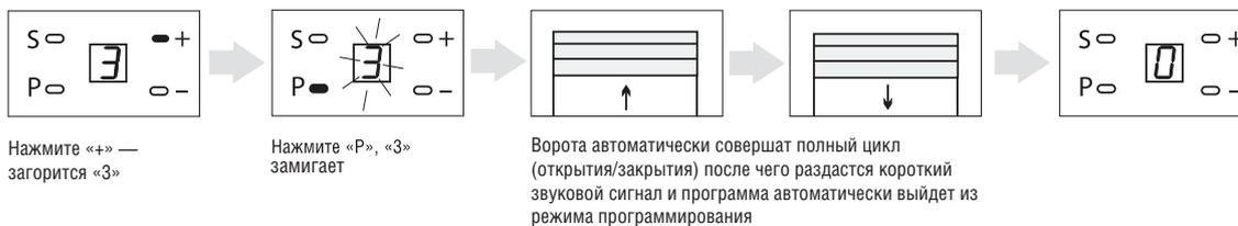
**После автоматической настройки усилия раздастся короткий звуковой сигнал и программа автоматически выйдет из режима программирования.**
